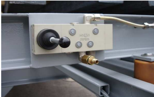
Figura 03: Válvula manual - sistema neumático
