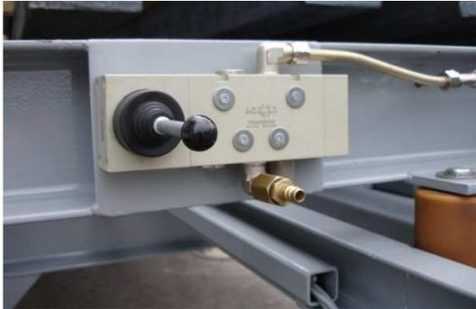
Bild 03: Handventil - Druckluftsystem
