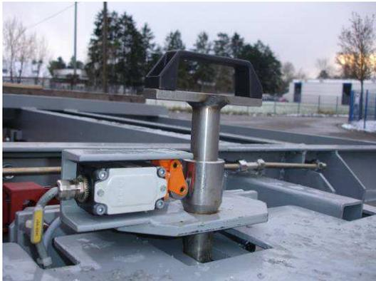
Bild 07: Sicherungsbolzen
