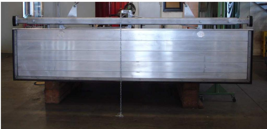
Bild 07 (Hakenbalken mit Dammtafel)
