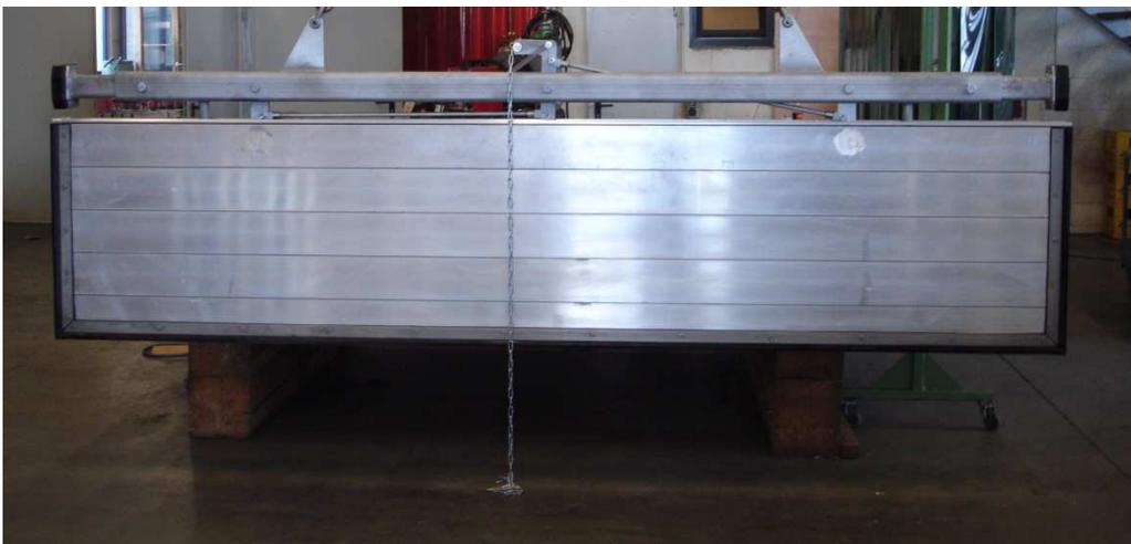
Bild 04 (Hakenbalken mit Dammtafel)
